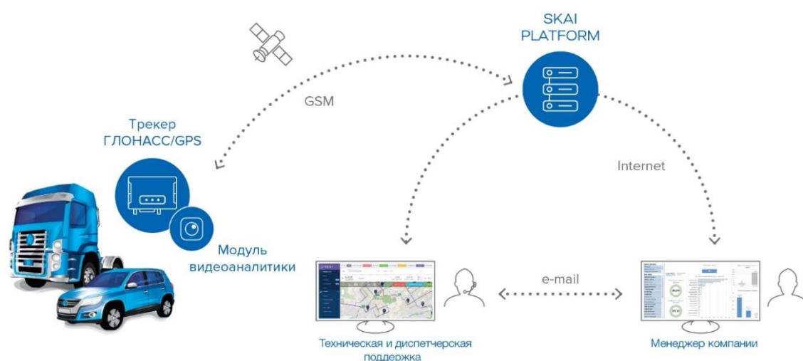
Рисунок 1. Схема взаимодействия Scout IoT Platform. Безопасное вождение
